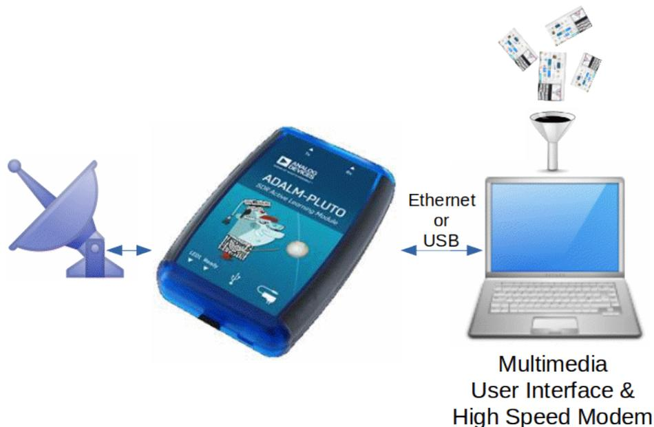
**Bild 6: Verwendung eines SDR-TRX mit dem Highspeed Multimedia Modem inclusive der GUI auf einem Windows-PC**
